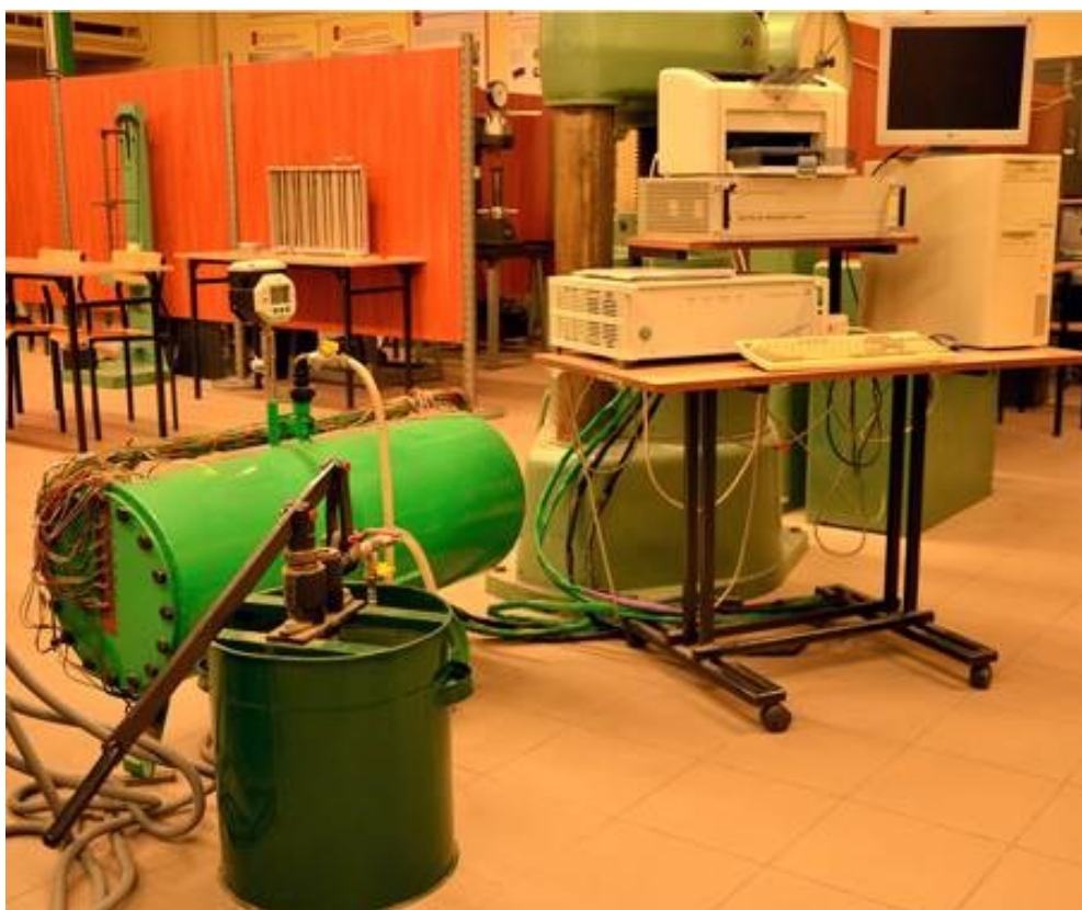
Rysunek 14.3. Widok stanowiska do badania zbiornika ciśnieniowego.
