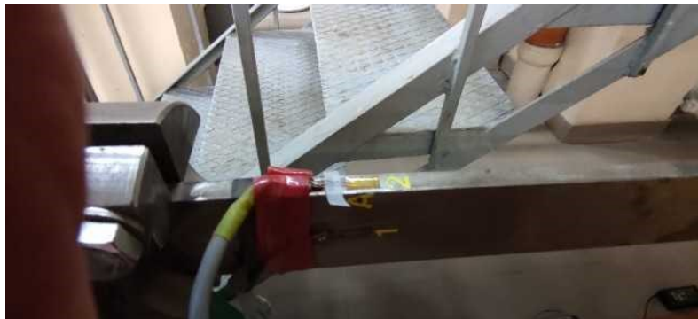
Rys. 15.5 Stanowisko do badań zginania płaskiego i ukośnego: a) widok ogólny stanowiska; b) pomierzone wartości; c) mocowanie belki w uchwycie; d) tensometry pomiarowe
